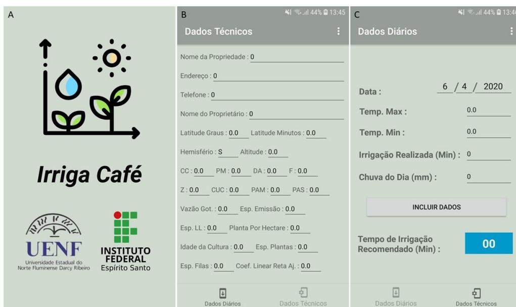
Figura 1. Telas do aplicativo Irriga Café desenvolvido para obtenção do tempo de irrigação do café. A. tela inicial; B. tela com dados técnicos; C. tela com dados diários.
