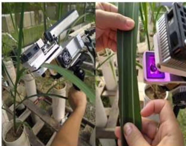
**Figura 10.** Analisador de gás a infravermelho (IRGA), modelo LI-6200 (LI- COR, Lincoln, NE, USA).
