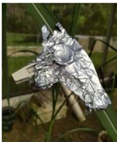
**Figura 11.** Pinças especiais (*leafclips*) (Hansatech) para adaptação no escuro, para medições de fluorescência de clorofila.
