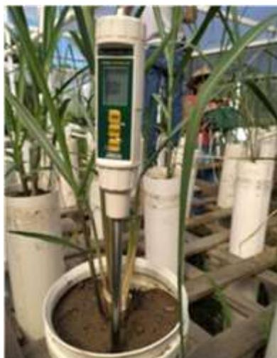
**Figura 12.** Sensor portátil para determinar a umidade do solo.
