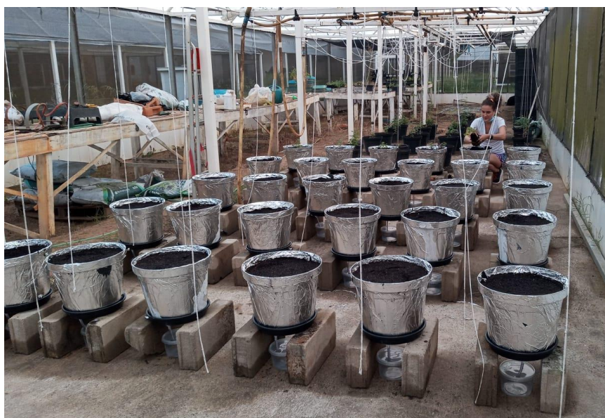
Figura 3. Disposição dos vasos, sob pratos plásticos, suspensos por blocos de concreto e abaixo recipientes para coleta da água drenada.
