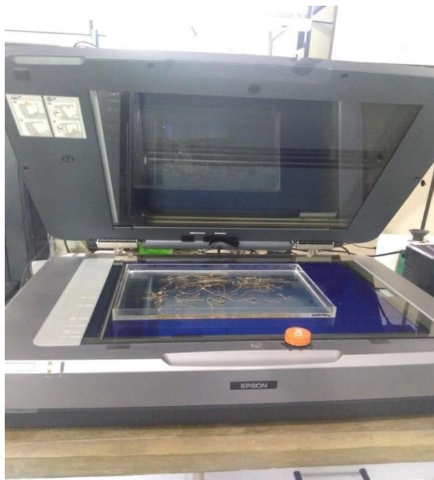
Figura 6A. Separação do sistema radicular e quantificação dos parâmetros comprimento radicular (CR, em cm), volume radicular (VR, em  $\text{cm}^3$ ), diâmetro médio radicular (DR, em cm) e área superficial radicular (ASR, em  $\text{cm}^2$ ), utilizando o software WinRhizo
