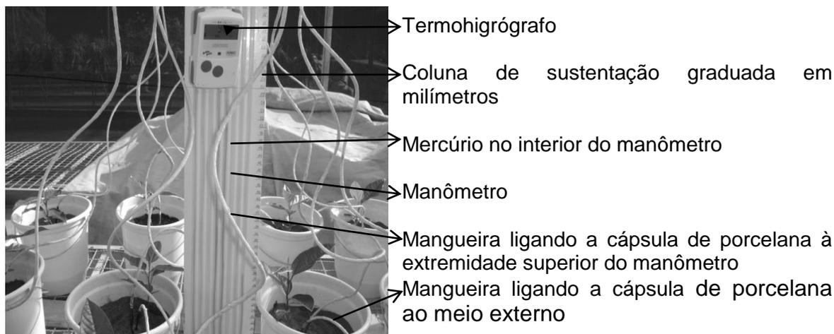
Figura 2. Descrição do aparelho usado nas aferições das tensões de água no substrato.
