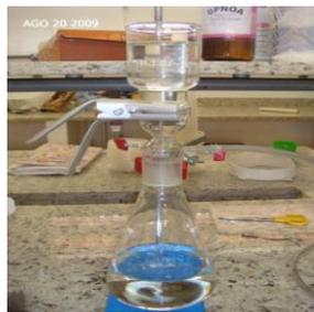
Figura 6 – Sistema Millipore de filtração.
