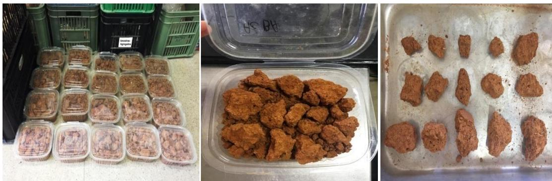
Figura 1. Amostras de agregados naturais de solo utilizados nos ensaios de infiltração de água e etanol.
