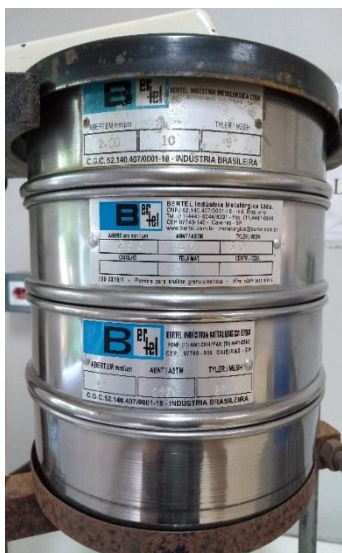
Figura 2: Separação das classes de agregados do solo por tamizamento via seco com jogo de peneira de diferentes diâmetros.
