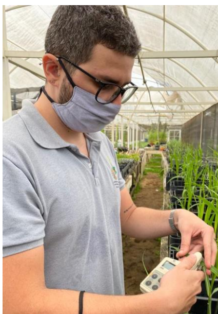
Figura 13. Medição da intensidade de verde das plantas do experimento com auxílio do medidor de clorofila portátil modelo SPAD – 502 ( Minolta Company, Japan ).
