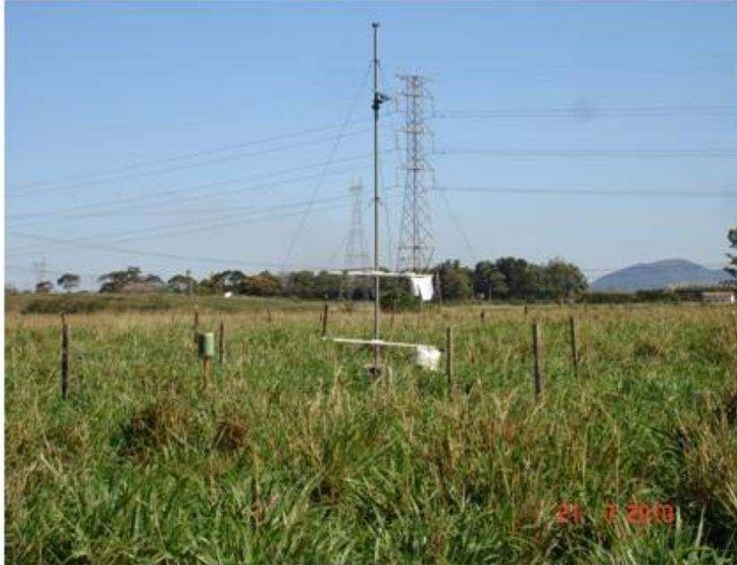
Figura 4.4. Estação micrometeorológica instalada sobre a área ocupada por capim Mombaça.
