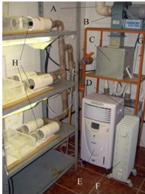
**Figura 2.** Olfatômetro horizontal de dupla escolha e sistema de purificação e umidificação do ar: (A) tubo para a sucção do ar externo; (B) exaustor; (C) filtro de carvão ativado; (D) banho-Maria adaptado; (E) climatizador; (F) aquecedor; (G) termo-higrômetro; (H) arenas.
