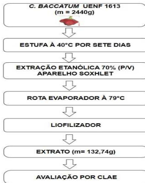
Figura 15. Esquema da obtenção dos extratos etanólicos dos frutos de Capsicum baccatum . CLAE - Cromatografia Líquida de Alta Eficiência.
