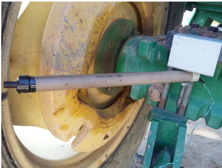
Figura 3. Detalhe de instalação do sensor *rede switch* montado próximo à roda traseira do trator.
