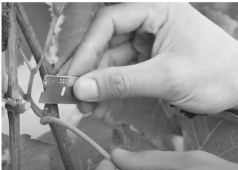
**Figura 4:** Corte do pecíolo e retirada da amostra de uma videira para uso na câmara de pressão. Fonte: Levin (2018).
