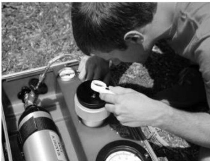
**Figura 10:** Operador utilizando uma lente de aumento para identificar o *endpoint* de uma amostra na câmara de pressão. Note-se a falta de dispositivo de proteção individual (óculos de segurança). Fonte: Edaphic (2021).
