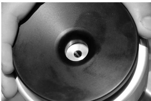
**Figura 9:** Aperto da tampa e do selo de borracha, exibindo a extremidade do pecíolo de uma amostra na câmara de pressão. Fonte: Edaphic (2021).
