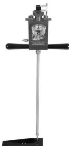
**Figura 6:** Câmara de pressão modelo Pump-up, da PMS Instrument Company. Fonte: PMS Instrument (2021).
