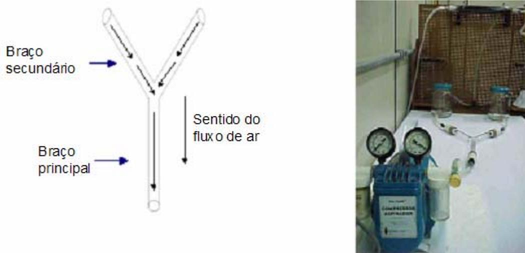
Figura 1 - Esquema do olfatômetro de duas vias, modelo em “Y”, (Esq.).
