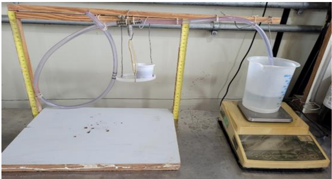
Figura 5: Método da sortividade intrínseca na infiltração inicial
