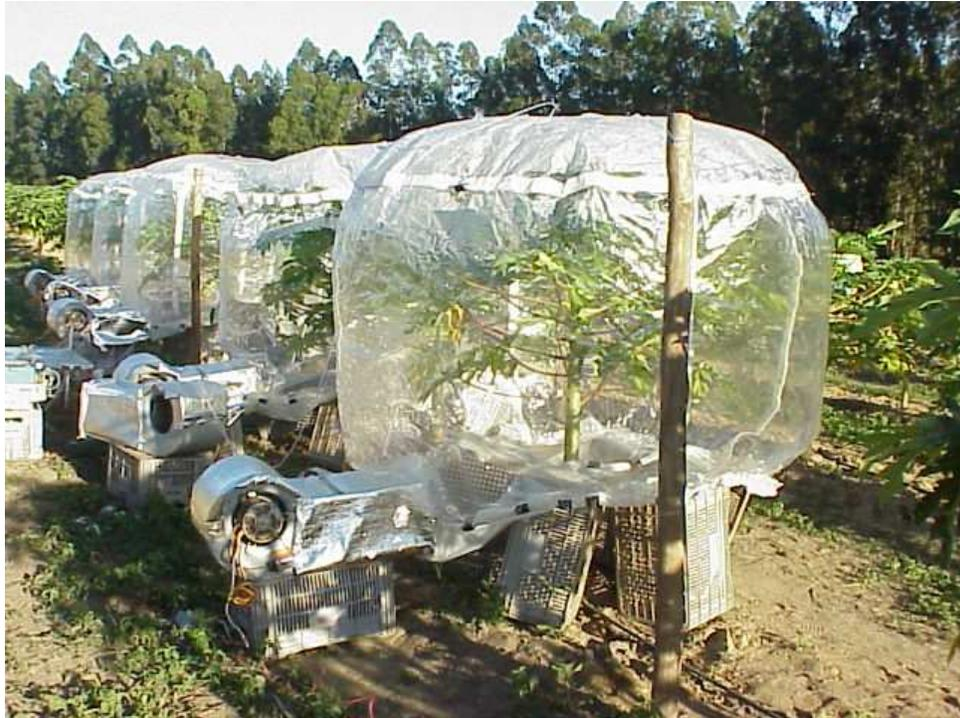
Figura 1. Esquema do aparato utilizado para a medição das trocas gasosas na planta inteira. O mamoeiro foi coberto por um balão feito de filme de poliéster transparente Mylar<sup>®</sup>, acoplado a um ventilador.
