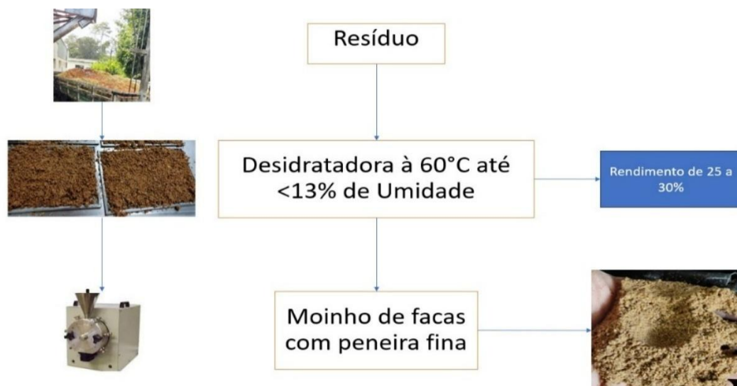
Fluxograma 1 - Produção de farinha de resíduo de goiaba
