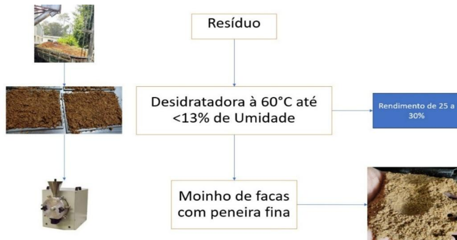
Figura 1 - Fluxograma de produção de farinha de resíduo de goiaba
