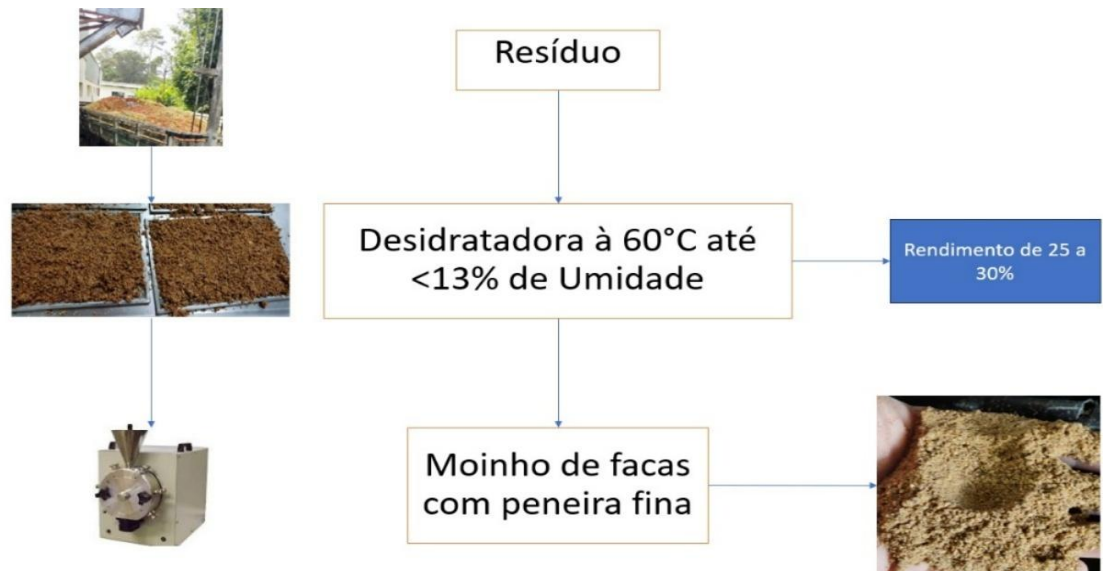
Figura 3: Fluxograma de produção de farinha de resíduo de goiaba
