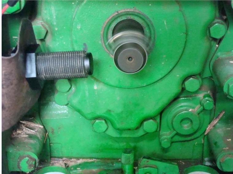
Figura 7 – Sensor indutivo usado para determinar a frequência da TDP.
