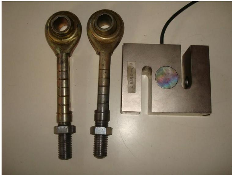
Figura 8 – Célula de carga usada para determinar a força de tração.
