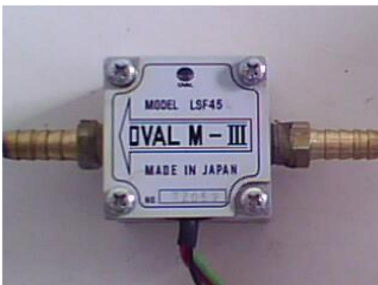
Figura 5 – Sensor para determinação do fluxo de combustível.
