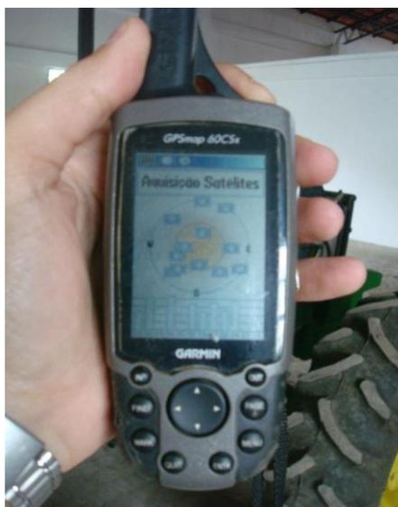
Figura 10 – Aparelho de GPS usado para a determinação da posição do trator.
