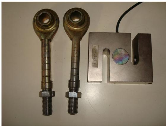
Figura 7 – Célula de carga, sensor usado para determinar a força de tração.
