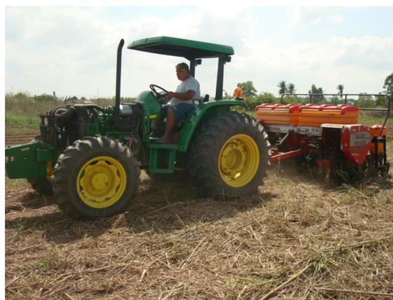
Figura 3 – Trator modelo John Deere 4x2 TDA com a semeadora-adubadora acoplada, usado na semeadura direta.
