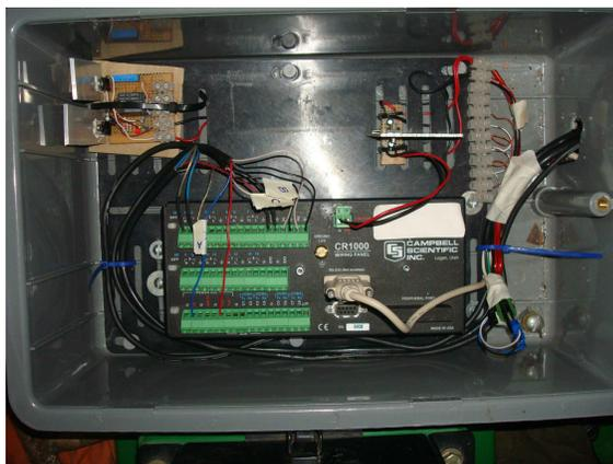
Figura 6 – Coletor de dados utilizado no trabalho.
