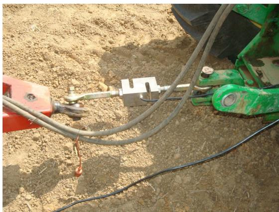
Figura 7 – Detalhe da célula de carga durante o trabalho.
