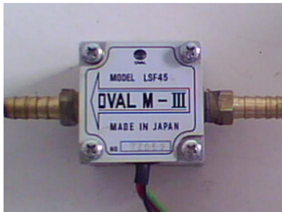
Figura 6 – Sensor para determinação do fluxo de combustível.
