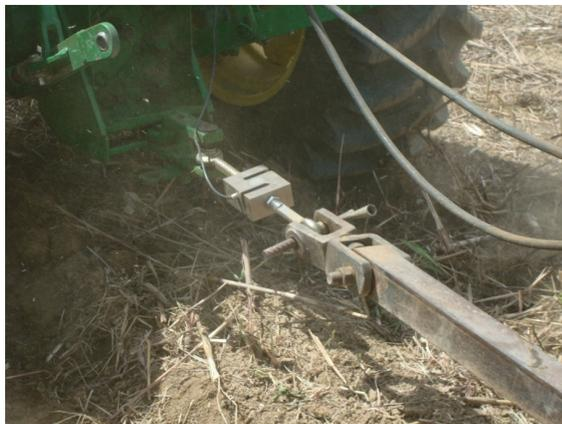
Figura 8 – Montagem da célula de carga durante o trabalho.
