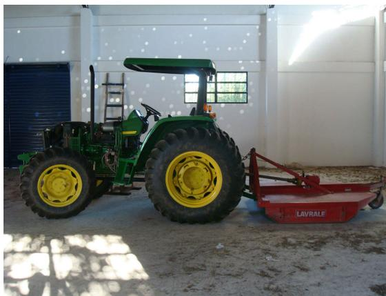
Figura 2 – Trator modelo John Deere 5705 4x2 TDA com a roçadora Lavrale AT-8180 ER montada.
