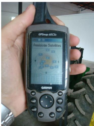
Figura 5 – Aparelho de GPS utilizado para a determinação da posição do conjunto trator e roçadora.
