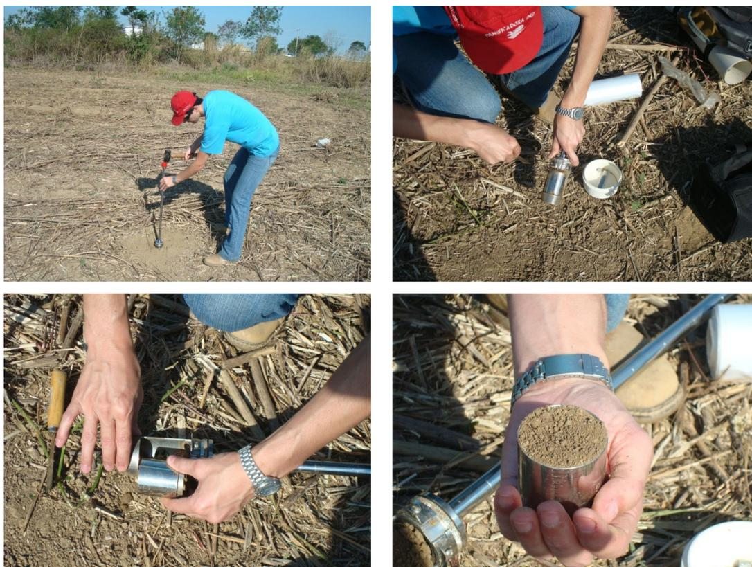
Figura 2 – Coleta das amostras de solo para a determinação do teor de água e densidade.
