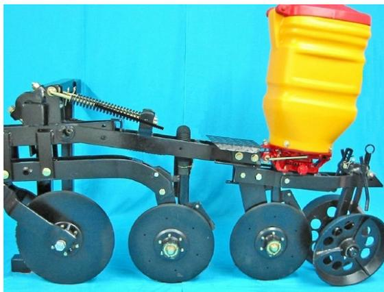
Figura 4 – Sulcadores do tipo discos duplos defasados para adubo e sementes.
