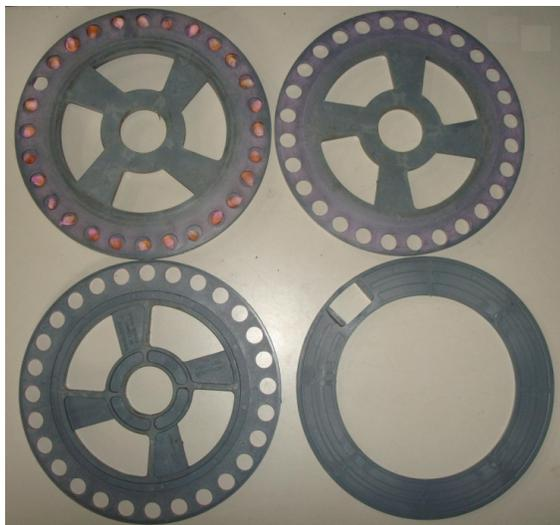
Figura 5 – Discos perfurados horizontais de 28 células usados para semeadura direta e convencional do milho.
