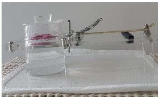
**Figura 8.** Dispositivo em acrílico para análise de molhabilidade das amostras em pó.
