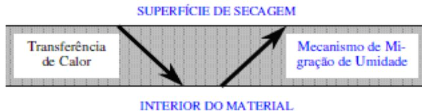
**Figura 3.** Diagrama da transferência simultânea de calor e massa, envolvendo a migração de umidade do interior do material para a sua superfície, no processo de secagem (Park et al., 2007).
