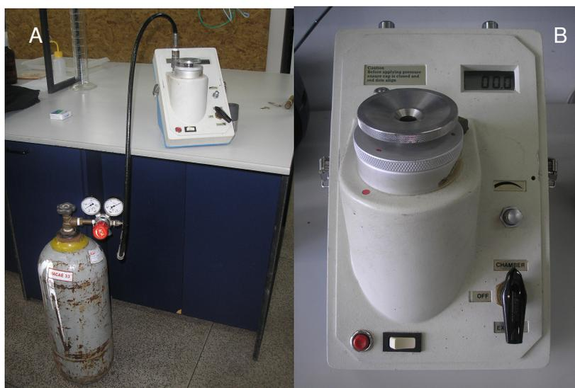
**Figura 2.** A. Bomba de Sholander Dickson<sup>a</sup> com o cilindro de nitrogênio. B. Bomba de Sholander fechada, tendo-se na parte superior direita o indicador da pressão.
