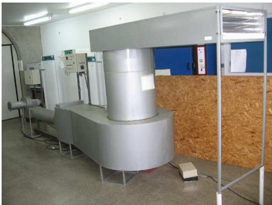
Figura 1A. Secador protótipo de camada delgada utilizado no experimento
