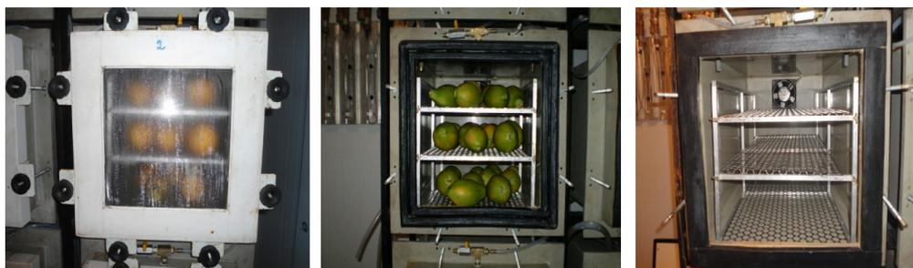
Figura 3 – Microcâmara fechada com frutos (a), microcâmara aberta com frutos na estante (b) e microcâmara aberta com estante e ventilado instalado na parte superior.
