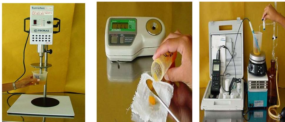
Figura 5 - Homogeneizador Turratéc TE-102 (a); Refratômetro digital Atago (b); potenciômetro, determinação da acidez total e sistema de agitação (c).
