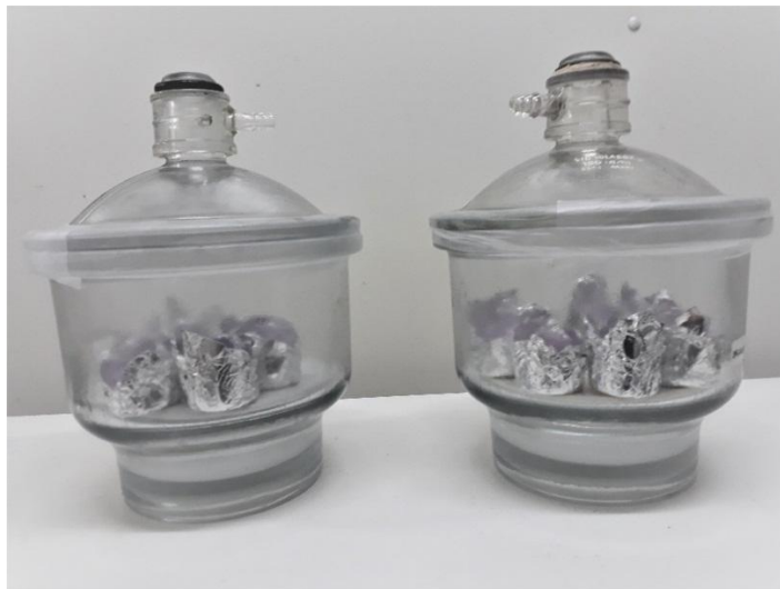
Figura 4. Foto do pó seco armazenado em dessecador durante a análise de higroscopicidade a 25°C.
