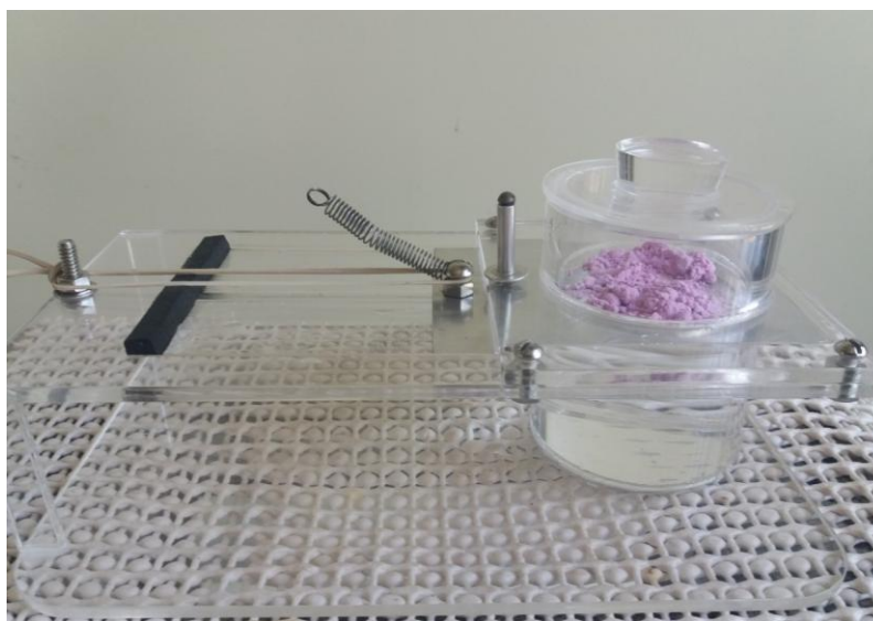
Figura 3. Dispositivo em acrílico utilizado para a determinação da molhabilidade dos pós.
