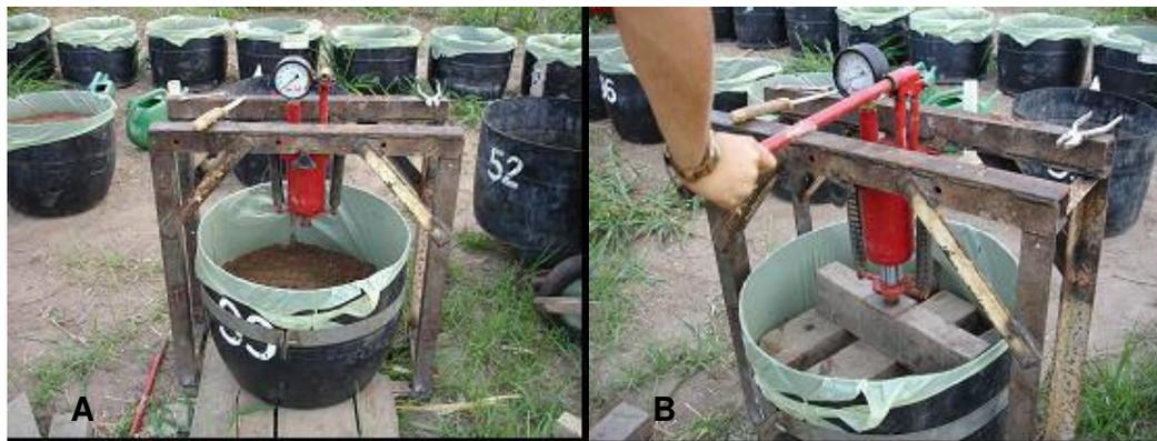
**Figura 2:** Prensa hidráulica utilizada na compactação durante o acondicionamento do solo nos vasos.
