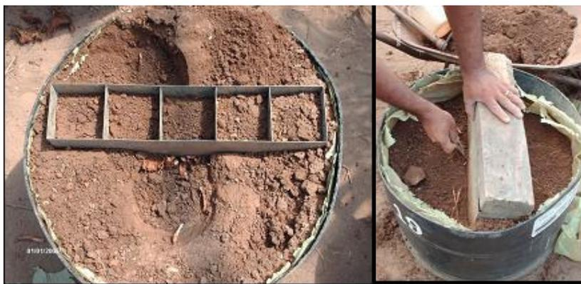
**Figura 5:** Amostrador utilizado na coletada do solo para avaliação do sistema radicular das plantas.
