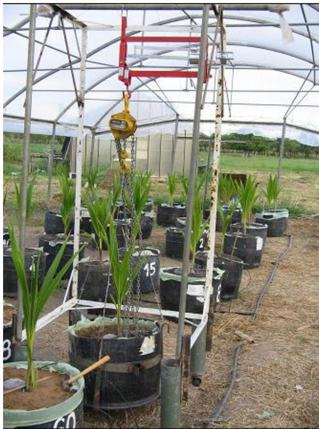
**Figura 4:** Conjunto balança-talha e estrutura de metal utilizada na pesagem dos vasos.
